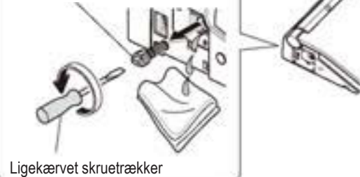
Afløbsventil med filter
